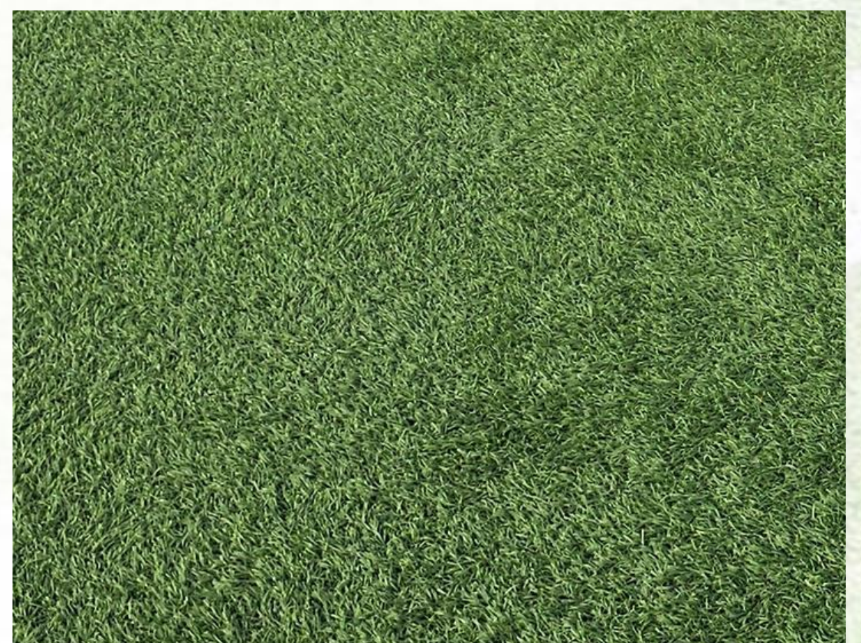
Esempio di un campo fuori uso con le fibre irrimediabilmente appiattite.
