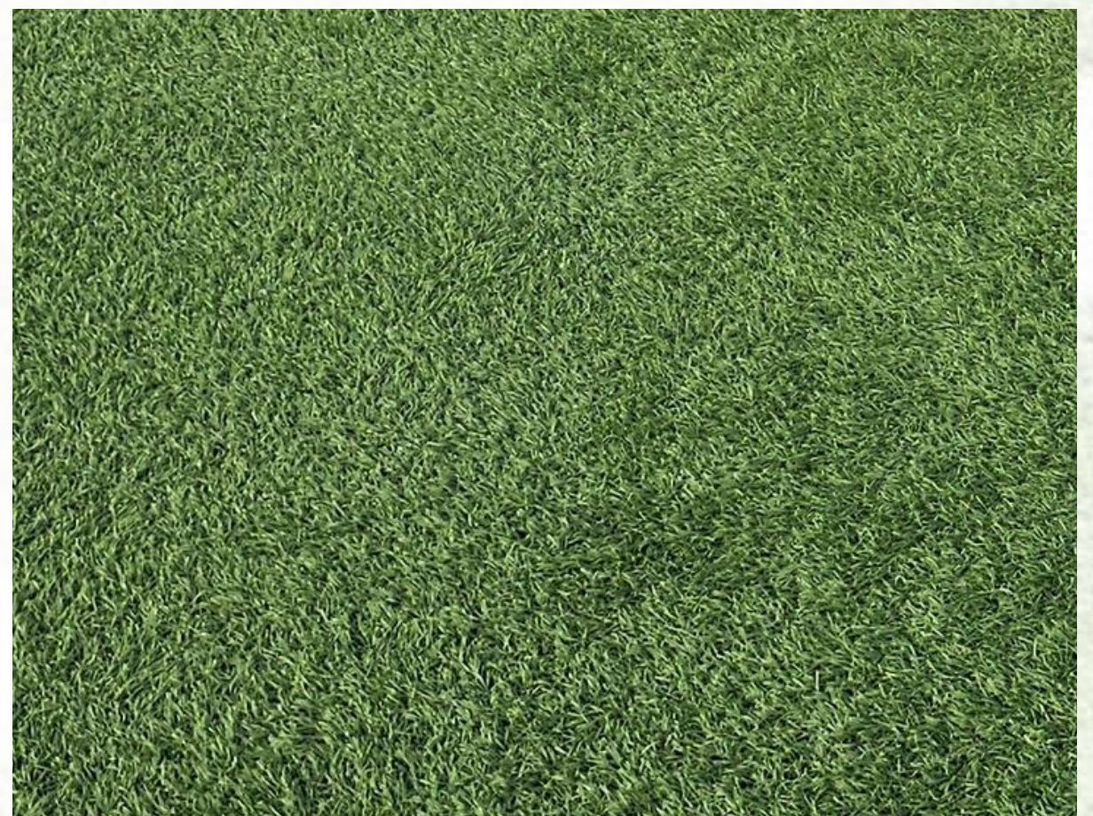
Eksempel på en bane, der er ude af drift, med fibre der er uopretteligt fladtrykte
